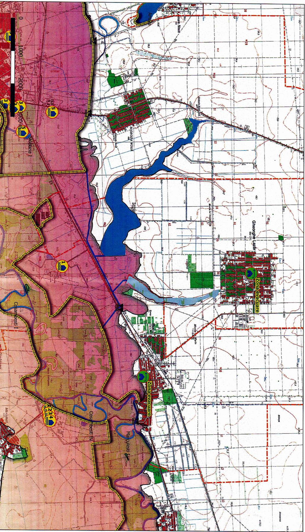
Planul de situație cu curbe de nivel, cu localizarea obiectivelor afectabile, delimitarea zonelor inundabile (cu probabilitatea de depășire de 0,1%) din revărsările de cursuri de apă, amplasarea construcțiilor hidrolehnice cu rol de apățare împotriva inundațiilor, mire locale, supratraversari cursurilor de apă, precum și a zonelor de evacuare preventivă și cazare a populației, animalelor și bunurilor.
